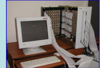
Экспериментальный образец сервера на основе БИС (0,6 мкм) с архитектурой МиниТера
